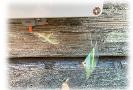
Montage des Elektronikgehäuses : Deckel abschrauben und am Außenrand des Unterteiles sind 4 Befestigungslöcher . Das Gehäuse sollte mindestens 2x Diagonal angeschraubt werden. Deckel wieder montieren (Achten sie auf die wasserfeste Dichtung das diese gut einrastet beim zuschrauben.
