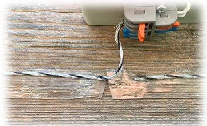
Kontrolle ob am Zaunband Schockimpulse ausgegeben werden ,können sie mit der mitgelieferte Led die auf das Elektrozaunseil gehalten wird anzeigen.
